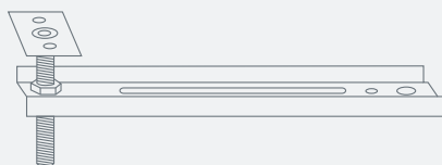
Kotwa dolna przeznaczona do montażu okien bez listwy progowej
