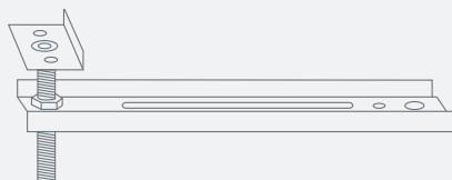
Kotwa dolna przeznaczona do montażu okien i drzwi z listwą progową
